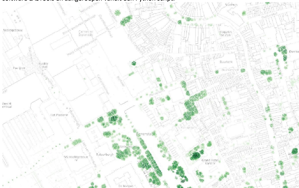
Figure 2: Canopy Height Model, de hoogte boven het terrein voor de vegetatie
